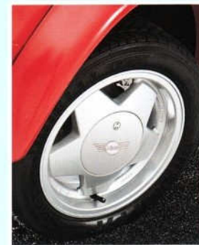
MINI ALLOY WHEEL (5 SPOKE) WHEEL DIMENSION 6J X 13"
